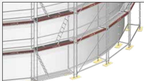
La **horizontal "U" angular** (0,73 m. / 15° – 44°) **3** se utiliza en andamios circulares de gran diámetro elaborados con pié común (un sólo vertical interior).
