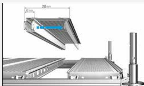
Para obtener una superficie sin huecos se puede utilizar la **plataforma telescópica cubre huecos 6**. Se adapta de forma rápida y flexible a cualquier dimensión para solventar los problemas normativos y de seguridad que los huecos producen.
