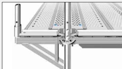
La **lámina cubre huecos 5** se puede utilizar entre dos plataformas de andamio tanto del sistema Blitz como Allround. El hueco máximo a cubrir será de una anchura de hasta 13 cm.
