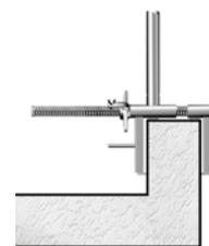
Cuando la mordaza se instala en forjados, se deben colocar rodapiés, y el montante vertical debe ser fijado sobre el eje.
