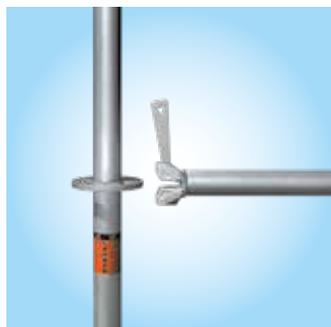
A medida que la cabeza con cuña es empujada sobre la roseta, la cuña cae automáticamente en el hueco y **queda asegurada de inmediato contra cualquier posibilidad de giro o extracción.** Esto significa un montaje seguro, sea cual sea la altura.
