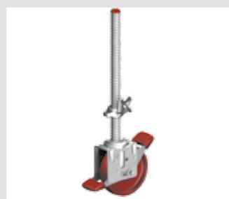
**Rueda 1000.** De plástico con base de chapa. Diámetro 200 mm. Rango de ajuste 0,30 – 0,60 m. Tuerca del husillo con bloqueo, con freno doble y centrado de carga en la posición de frenado. Bloqueo de la rueda y del husillo. Carga 10 kN (con o sin freno). Peso 6,30 kg.
