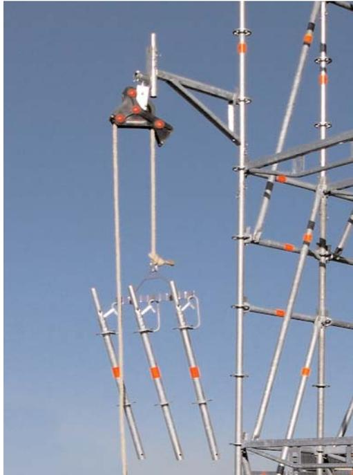
La polea con freno de seguridad permite que al soltar la cuerda el operario tenga la certeza de evitar la caída del material al suelo, impidiendo los posibles accidentes.
