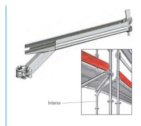
Esta horizontal en "U" de 0,73 m. permite ángulos desde 15º a 44º, que se requieren para andamios circulares de gran diámetro elaborados con pié común (un sólo vertical interior). Si el radio del andamio circular demanda un ángulo inferior de 45°, el montaje con plataformas al mismo nivel es posible gracias a esta horizontal en "U" conectada al vertical interior. Ya no es necesario un segundo vertical interior.
