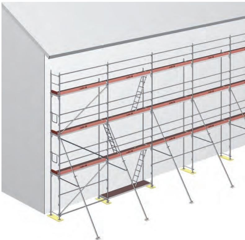
El estabilizador se puede unir al andamio muy rápidamente mediante las grapas con cuña incorporadas. Para asegurar los pies se pueden utilizar dos clavijas o cuatro pernos.
