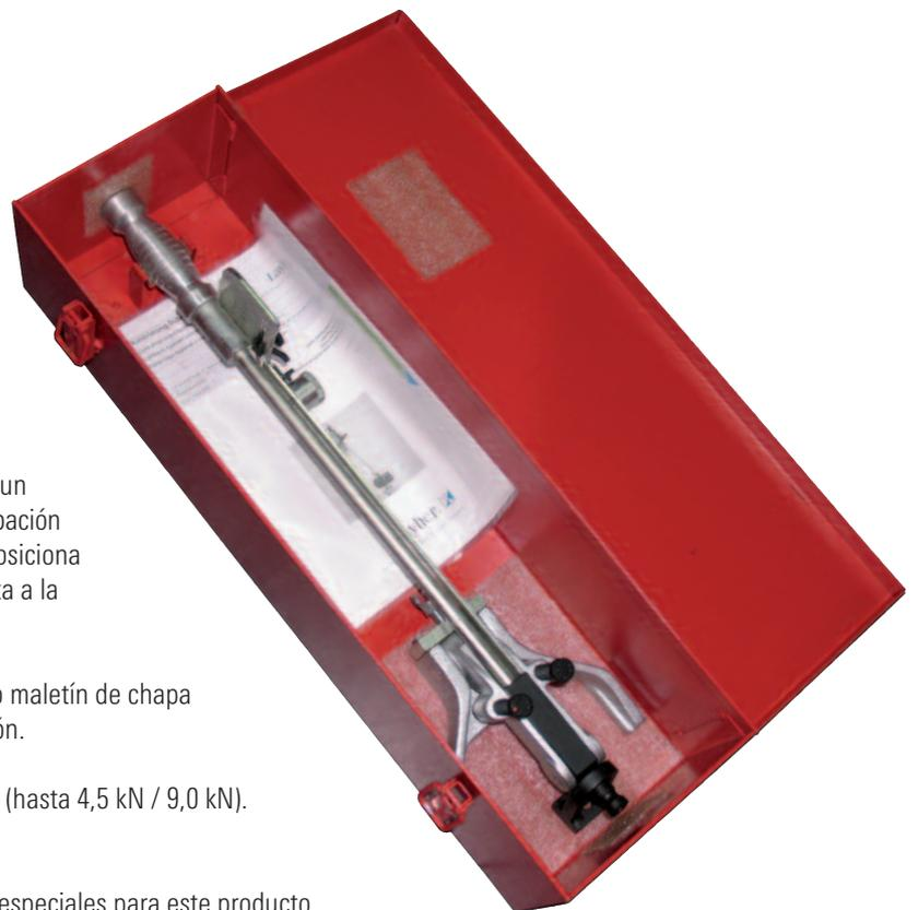
El comprobador de tacos, o comprobador mecánico de anclajes, de Layher (ref. 4012.000), es un aparato que está diseñado para realizar una comprobación prescriptiva del arriostramiento de andamios y se posiciona como un elemento imprescindible en lo que respecta a la seguridad.
