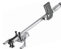
Aparato **Comprobador de tacos** con mando manual, en un práctico maletín con dos zonas de trabajo (hasta 4,5 kN / 9,0 kN). Las cargas de pruebas se leen en la correspondiente escala y anotadas en el protocolo de pruebas. Tolerancia del aparato de comprobación de tacos  $\pm 15\%$ .
