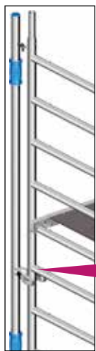
Fig. 4: Conexión del mástil al marco
