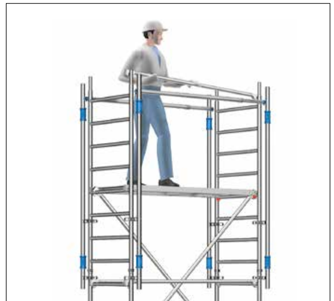
Fig. 6: Colocación segura de las barandillas con AGS
