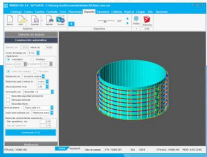
Andamio exterior o interior típicos para mantenimiento de **tanques cilíndricos** para depósito de almacenamiento.
