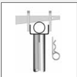
Detalle del soporte de la cubierta.
