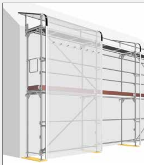
Uso de lona Keder en un andamio.
