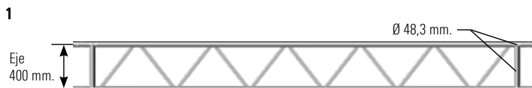
Posibilidad de conexión con grapa a viga ref. 4904
