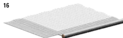
Lona de rejilla reforzada y protegida UV con jareta soldada en ambos lados (Ø 13 mm.). Para módulos de andamios de 2,07 / 2,57 y 3,07 m. Peso 300 g/m 2 . Las lonas Keder pueden ser fabricadas en otras longitudes y anchos (por ejemplo: métrico). Para más información consúltenos.
